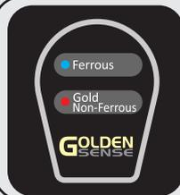
Cuando encienda el detector, escuchará una melodía y los LEDs se iluminarán. 20 segundos más tarde, aproximadamente, los LEDs se apagarán y escuchará un tono para indicar que ya puede empezar a utilizar el detector.
