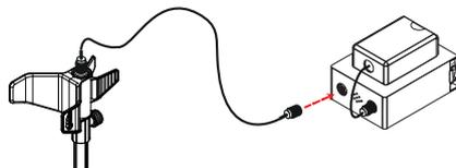
Enchufe el conector del cable en la caja de control y apriete.
