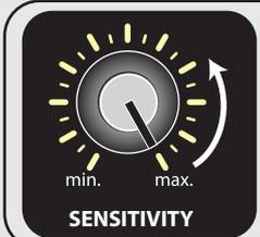
Si el detector emite señales falsas por interferencias, reduzca la sensibilidad hasta que las señales desaparezcan. Después siga buscando.
