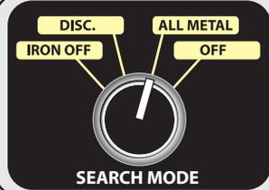
Para encender el detector, gire el control del modo de búsqueda al modo deseado. Para apagarlo, sitúe el control en posición OFF.
